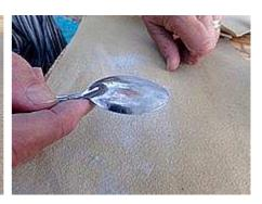
Fignolez en ponçant avec du papier de verre ou de la toile émeri fine à l'intérieur comme à l'extérieur du cuilleron
